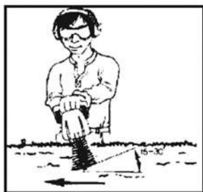
Рис. 2 Движения ножницами при обрезке
