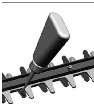
Рис. 3 Смазка режущих ножей
