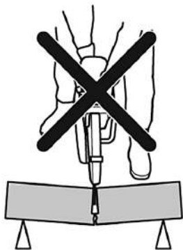
Рис. 14 Отдача при защемлении диска
