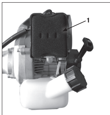
Рис. 15 Обслуживание воздушного фильтра ТА2
