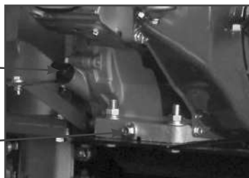
Рис. 10 Проверка уровня масла в картере
