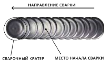
Рис. 12.4. Начало сварки при смене электрода.
