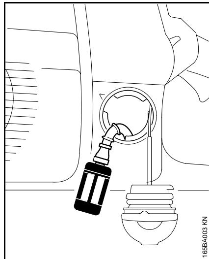
**Ежегодная замена топливного всаса в топливном баке**
