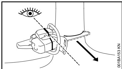
Выбранное направление валки дерева при проведении подпила может контролироваться с помощью валовой планки на кожухе, а также на корпусе вентилятора моторной пилы.
