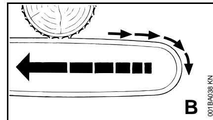
Если при пиления нижней стороной направляющей шины – передний рез – пильная цепь защемляется или наталкивается на твердый предмет в древесине, то пила может быть затянута рывком в сторону ствола, – **поэтому всегда устанавливайте надежно зубчатый упор!**
