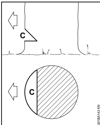
**C** = Подпил определяет направление валки дерева.
