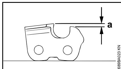
Ограничитель глубины определяет глубину врезания в древесину, т.е. глубину стружки.
