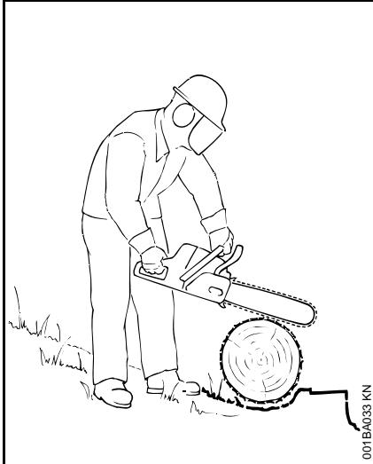
Мотопилу вставляйте в рез при полной подаче топлива и установите прочно зубчатый упор, – лишь после этого производите пиление.
