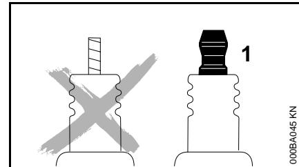
У свечи зажигания с отдельной соединительной гайкой
