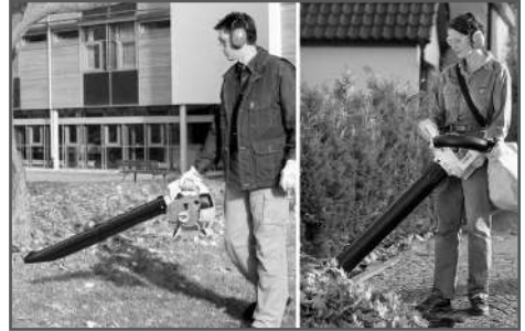
Рис. 9 Положение оператора при работе воздуходувным устройством
