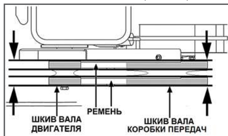
Рис. 23 Проверка соосности шкивов
