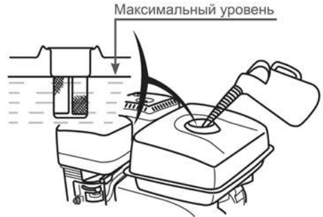
Рис. 7 Максимальный уровень топлива в топливном баке
