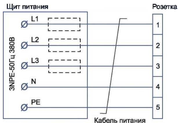
Рис. 6 Схема подключения розетки к стационарной электросети
