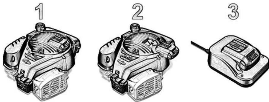
Рис. 19 Обслуживание аккумуляторной батареи
