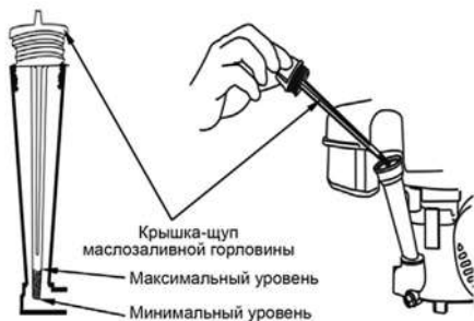
Рис. 7 Проверка уровня масла в картере
