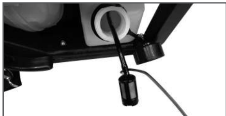
Рис. 11 Извлечение топливного фильтра
